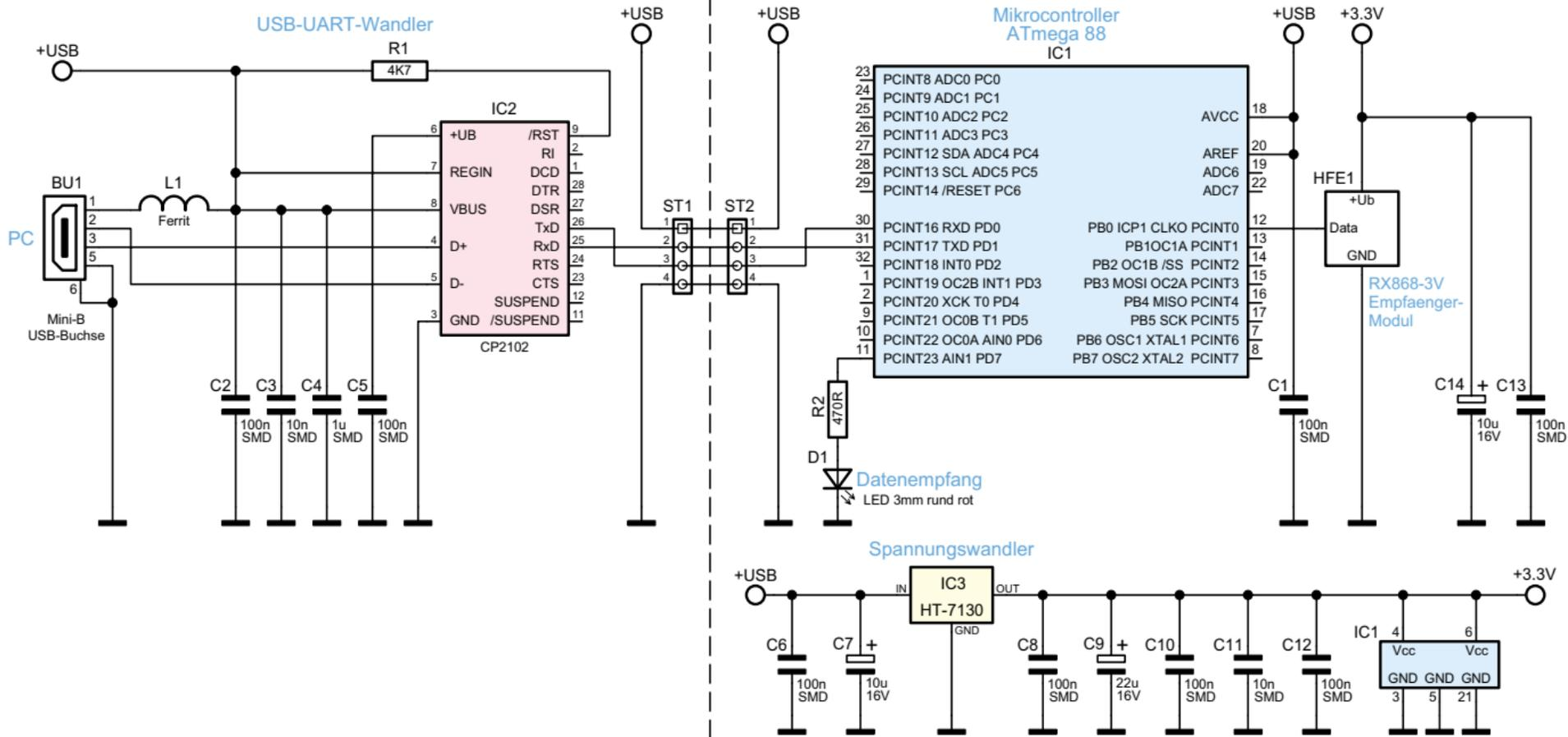
Bild 3: Die Schaltung des Wetterdatenempfängers
