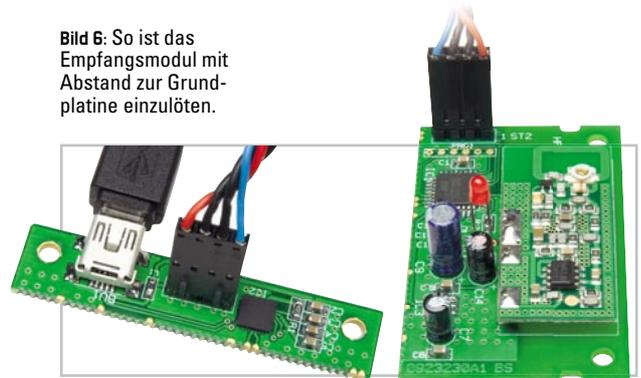
**Bild 7:** Die getrennten Platinen, betriebsfertig mit Stiftleisten bestückt und hier schon mit passenden Anschlussbuchsen angeschlossen
