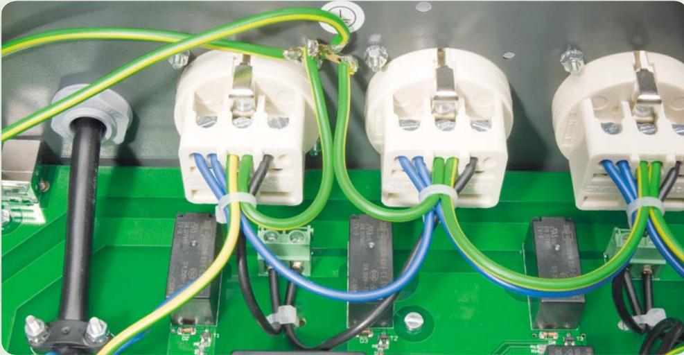
Bild 21: Montage der Einzelladern an die Steckdosen der Rückwand und Fixierung der Leitungen mit Kabelbindern mit Blick auf die Rückseite
