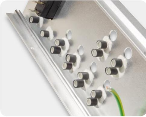
Bild 11: Aufsetzen der Schrumpfschlauchabschnitte zur Verhinderung der Lichtstreuung
