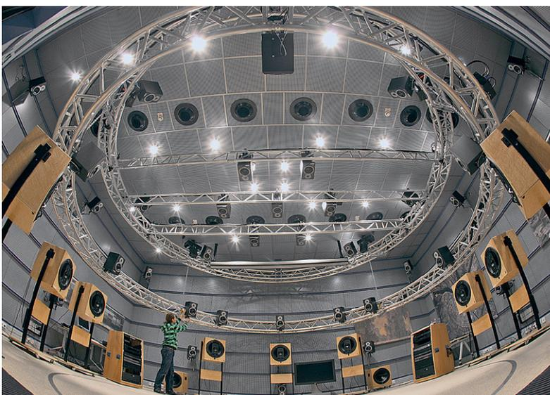
Bild 11: Weil bei der Entwicklung optimaler Audiocodierverfahren von Individuum zu Individuum unterschiedliche subjektive auditive Eindrücke berücksichtigt werden müssen, ist ein Akustiklabor für umfangreiche Hör-Testreihen unverzichtbar. Quelle: Fraunhofer IIS
