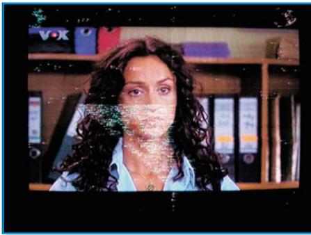
**Bild 9: Weiße Spikes = Receiver zu tief abgestimmt**
