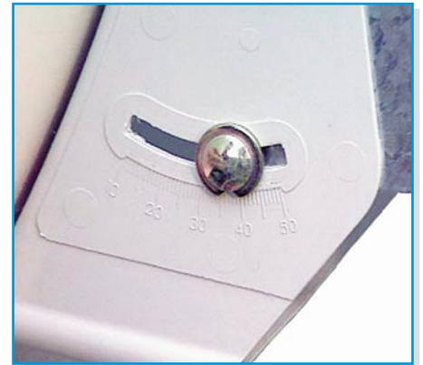
Bild 3: In der Elevationsskala einer Offsetantenne ist der Offsetwinkel bereits berücksichtigt.
