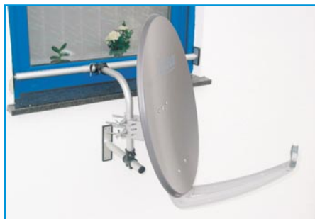
Bild 15: Antennenhalterung EasyMount, die sich in die Fensterlaibung spreizt und ohne Spuren wieder entfernt werden kann
