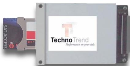
**Bild 16: In diesem CI-Modul für die TT PCLine premium kann ein CAM den Zugang zu verschlüsselten Programmen öffnen. (Quelle: TechnoTrend)**
