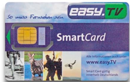
**Bild 8: Die Smart Card aktiviert das Conditional Access Module. (Quelle: MASC.COM)**
