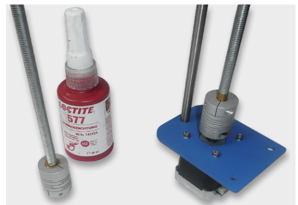
Bild 14: So haben wir die in der Wellenkupplung nicht fixierbaren Gewindestangen befestigt: links mit Gewindekleber, rechts mit einigen Lagen Kaptonband als Verstärkung.
