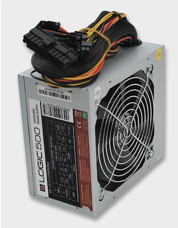
Bild 9: Als Netzteil kommt ein normales PC-Netzteil zum Einsatz, das genug Reserven auch für den Ausbau mit einem zweiten Extruder hat.
