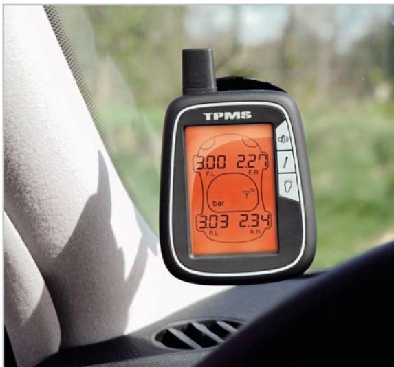
Bild 7: So angebracht, ist der Reifendruck-Monitor immer im Blickfeld – im Alarmfall macht er sich zusätzlich akustisch bemerkbar.
