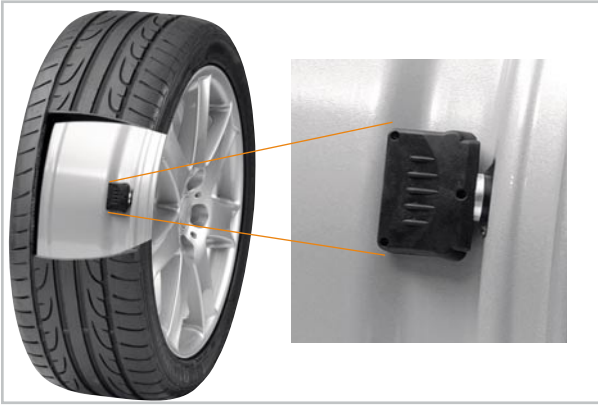
Bild 3: Hier ist der Sensor im Reifen direkt am Ventil eingebaut. (Bild: Hella KG)
