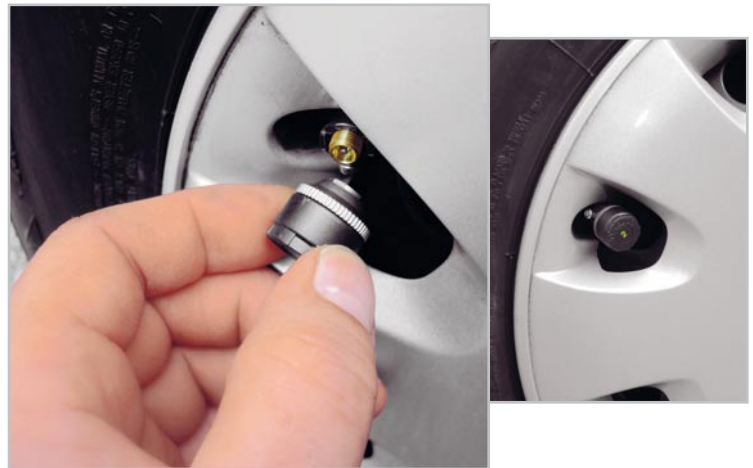
Bild 6: Die Sensoren werden, natürlich richtig zugeordnet, einfach statt Ventilkappe auf das Reifenventil geschraubt.
