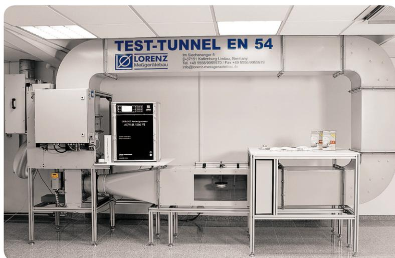
Bild 1: Rauchmelder-Prüfkanal nach EN 54
