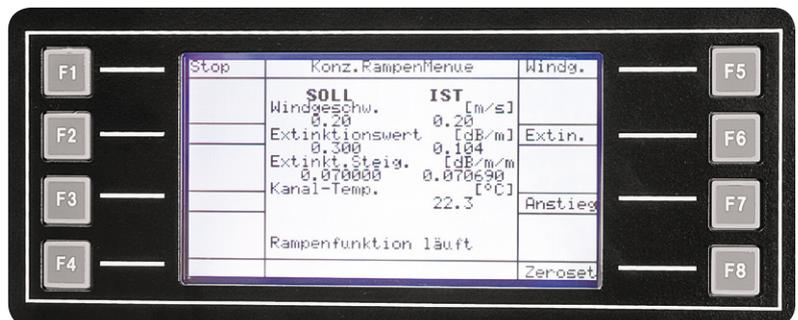
Bild 3: Bedienelemente und Display des Prozessrechners
