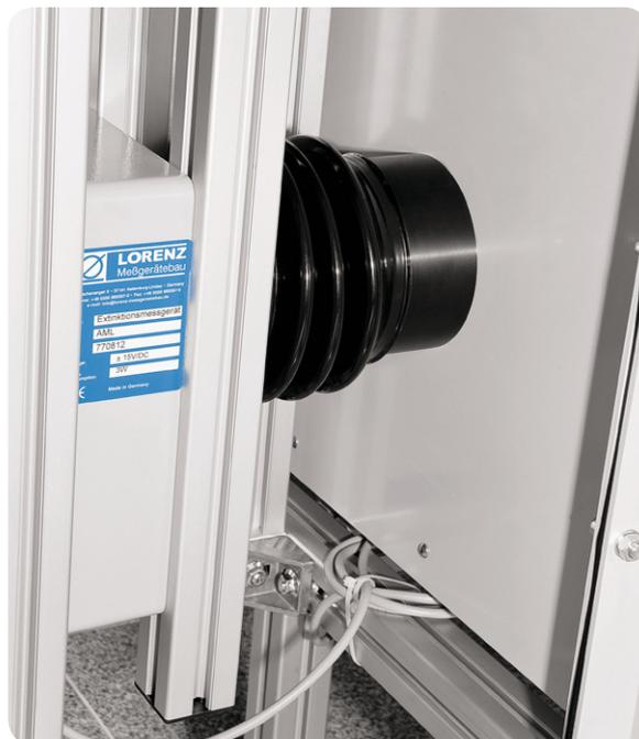
Bild 6: Extinktionsmessgerät zur Erfassung der Aerosolkonzentration
