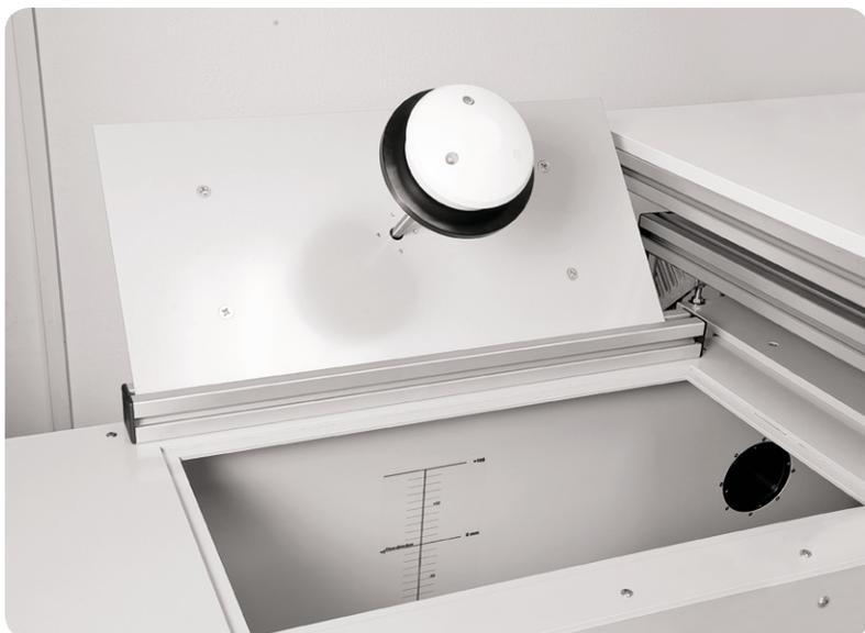
Bild 7: Montage des Prüflings am Drehteller
