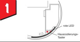
Den Hauscodierungs-Taster auf der Rückseite des Funkmoduls gedrückt halten, bis die rote LED aufleuchtet. Anschließend loslassen.
