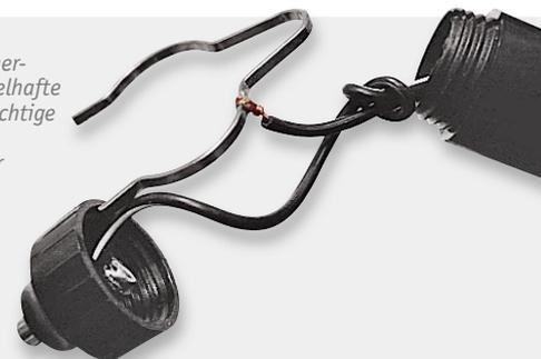
zudem vielleicht auch so manchen unruhigen Kilometer im Fahrzeug verbringt, nahe, führt dies unweigerlich zu einem Kurzschluss. Zumal die betroffenen Leitungen lang genug sind (und ungenügend fixiert), dass sie bei einem Lösen der Verbindung direkt an die offen liegenden Kontakte des Hauptschalters geraten können, der direkt mit dem Akku verbunden ist.
