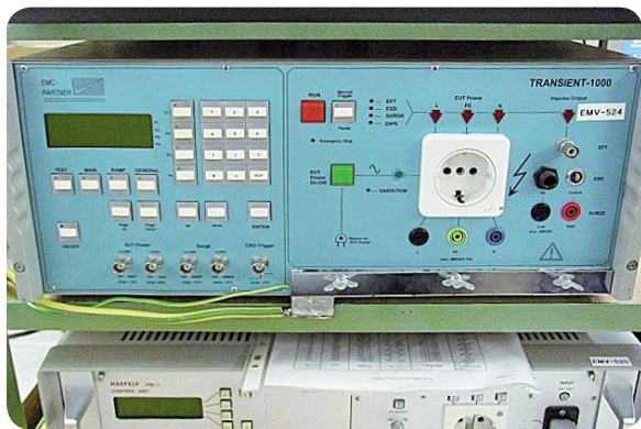
Bild 6: Das eingesetzte Messsystem Transient 1000
