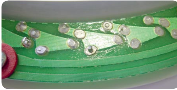
Bild 13: Schlechte, vergessene und falsch bearbeitete Lötstellen am LED-Ring, rechts kann man in der Seitenansicht sehr gut die nachträglich abgekniffenen Lötstellen sehen.
