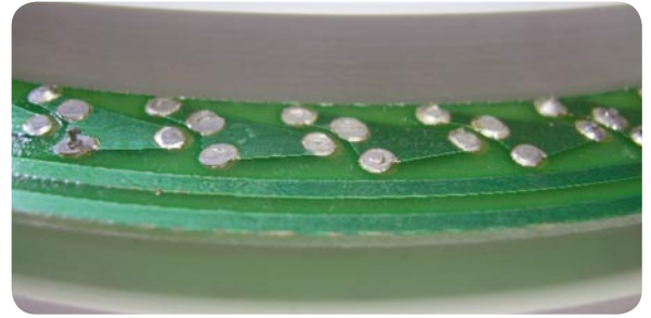
Bild 13: Schlechte, vergessene und falsch bearbeitete Lötstellen am LED-Ring, rechts kann man in der Seitenansicht sehr gut die nachträglich abgekniffenen Lötstellen sehen.
