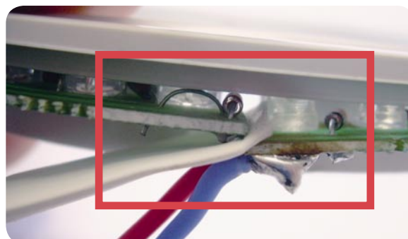
Bild 12: Gefährlich – die zu lange, sich überlappende Platine ist provisorisch mit einem Stück Schrumpfschlauch gegen Kurzschluss „abgesichert“.
