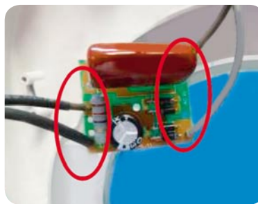
Bild 2: Nicht fixierte Leitungsenden auf der Netzteilplatine
