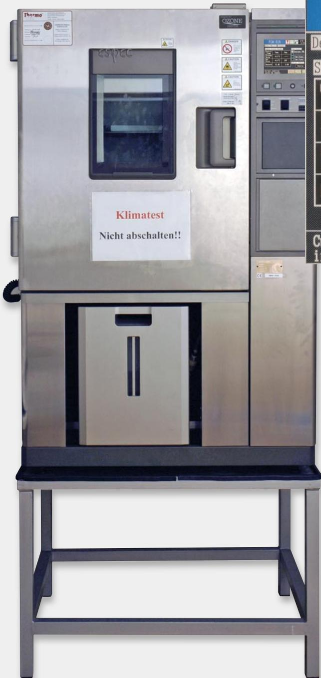
Bild 5: Klimaschrank für Temperaturmessungen ESPEC Typ PL-1KPH
