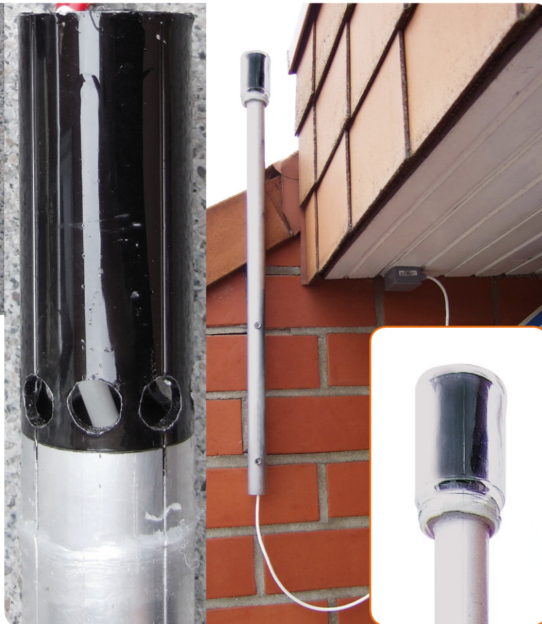
Bild 7: Der selbst gebaute Sonnensensor, links mit allen benötigten Teilen inkl. HomeMatic-Funk-Temperatursensor HM-WDS30-T-0, in der Mitte Details zur Gehäuseausführung, rechts in Betrieb mit aufgesetztem Glasbehälter
