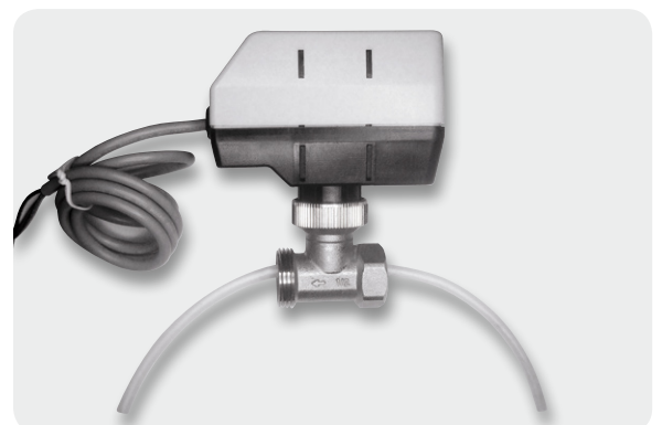
Bild 3: Zum Quetschventil umgebautes Thermostatventil mit elektromotorischer Betätigung
