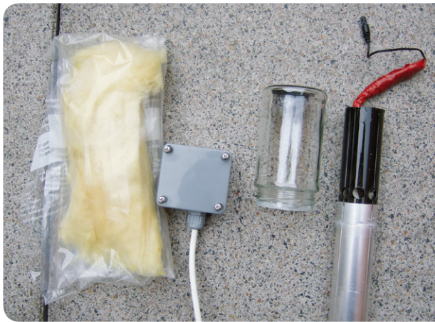
Bild 7: Der selbst gebaute Sonnensensor, links mit allen benötigten Teilen inkl. HomeMatic-Funk-Temperatursensor HM-WDS30-T-0, in der Mitte Details zur Gehäuseausführung, rechts in Betrieb mit aufgesetztem Glasbehälter
