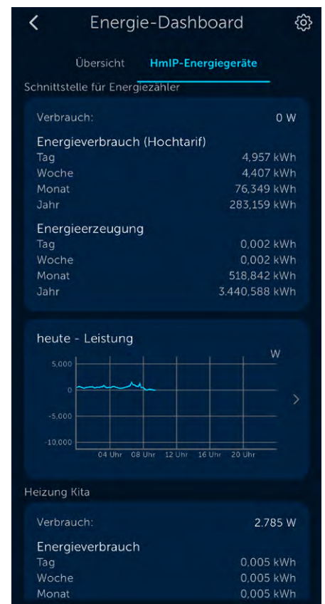
Bild 7: Energie-Dashboard der Homematic IP App mit der Home Control Unit
