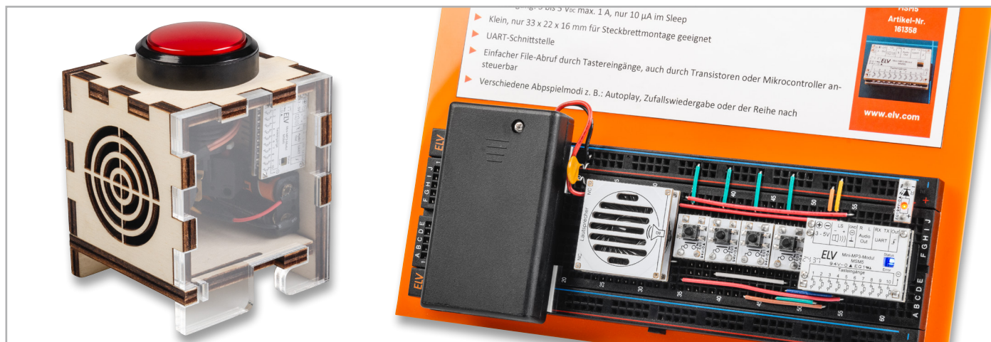
Bild 3: Demoaufbau mit Soundwürfel und mit einem Steckboard
