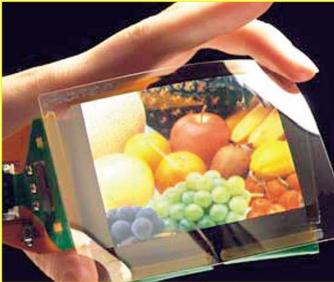
**Bild 16: OLED-Displays auf flexiblen Kunststoff- oder Metallsubstraten ermöglichen gekrümmte oder formangepasste Bildschirme. (Quelle: Pioneer)**
