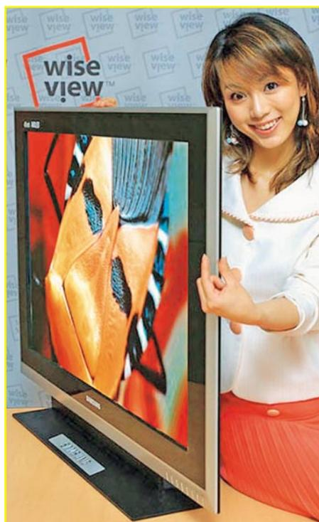
**Bild 14: Prototyp eines 40"-Displays mit weniger als 3 cm Dicke von Samsung**
