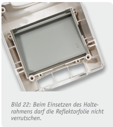
Bild 19: Einsetzen des Displays in das Gehäuseoberteil
