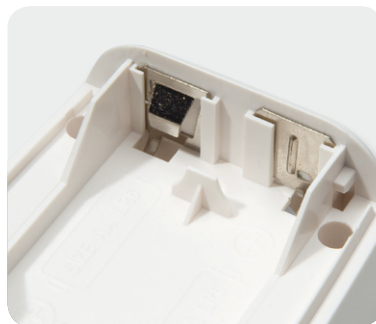
Bild 29: Einrasten der Batterie-Einzelkontakte
