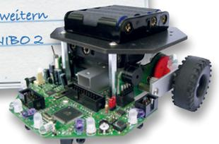
um ihn beim Annähern an eine Wärmequelle ausweichen zu lassen. Auf diese Weise kann man den Roboter selbstständig einen aus Teelichtern gebildeten Parcours durchfahren lassen. Da die Sensoren ohne weitere optische Hilfsmittel eingesetzt werden, erfolgt nur eine Erfassung in einem Bereich von 30 bis 50 cm, somit sind weiter entfernte Wärmequellen kein Störfaktor.
