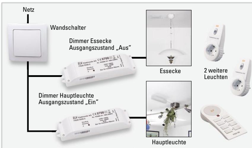
Bild 1: Die Konfiguration für die Beleuchtungslösung
