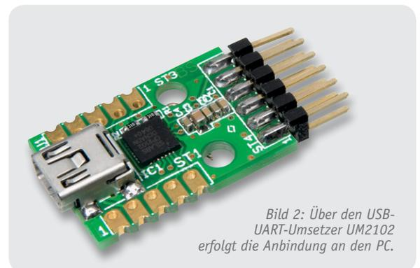
Bild 2: Über den USB-UART-Umsetzer UM2102 erfolgt die Anbindung an den PC.
