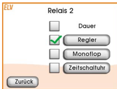
Bild 10: Die Seite iorelay.xml für die Auswahl des Relais-Betriebsmodus und die Verzweigung zur entsprechenden Konfigurationsseite
