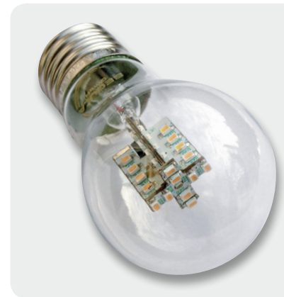
Bild 14: Würde ein Mattgaskolben bei dieser LED-Lampe verwendet, wäre die eingesetzte Technik nur an der geringen Lampenerwärmung bemerkbar.
