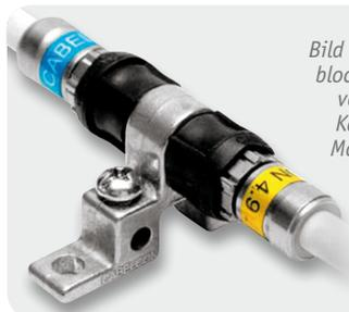
Bild 9: Ein derartiger Dichtungsblock verhindert das Eindringen von Nässe in einen koaxialen Kabelkuppler. Zugleich ist die Möglichkeit zur mechanischen Fixierung und Einbeziehung in den Potentialausgleich gegeben.
