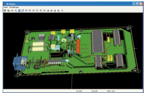
Bild 8: Tolles Tool – die Kontrolle der Bauteilanordnung über den 3D-Viewer
