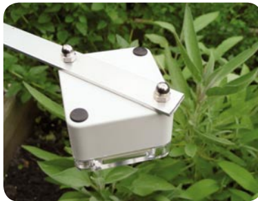
Bild 4: Um in den Schraubenlöchern stehendes Wasser zu vermeiden, wurden diese mit Gummistopfen verschlossen.
