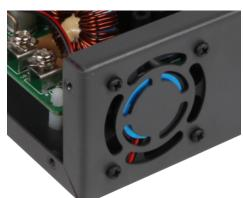
Nachdem die Kabel fertig sind und der Lüfter befestigt ist, können Sie nun die kleine Platine mit zwei Muttern am Gehäuse befestigen.
