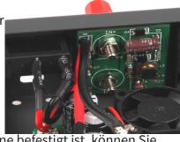
Wenn die kleine Platine befestigt ist, können Sie nun alle Kabel befestigen.
