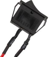
Damit kein Kurzschluss entstehen kann, werden die Kontakte mit Schrumpfschläuchen isoliert.
