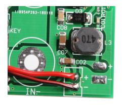
Das rote Kabel (+) müssen Sie an "+" verlöten und das schwarze Kabel (-) müssen Sie auf dem Board an "-" löten.
