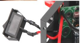
Nun können Sie die Hauptplatine mit vier Schrauben auf der Unterseite des Gehäuses befestigen und die Anschlüsse der Ein- und Ausgänge der Spannungsversorgung einbauen.
