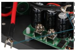
Beide Seiten müssen ca. 5 mm abisoliert werden, dabei muss am einen Ende der beiden Kabel ein Gabelkabelschuh befestigt werden. Diese Enden werden auch mit einem Schrumpfschlauch isoliert, um einen Kurzschluss vorzubeugen. Das andere Ende der beiden Kabel muss auf die kleine Platine des Gehäuses gelötet werden.
