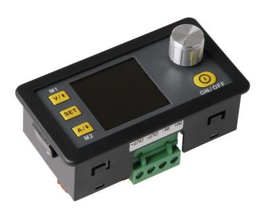
Die Eingangsspannung und die Ausgangsspannung des Gehäuses müssen Sie nämlich dann an den vorgesehenen 4-poligen Stecker anbringen.
