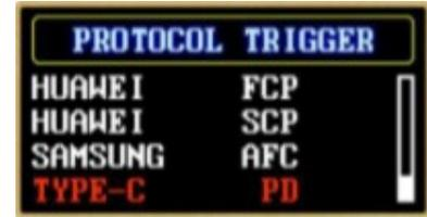
Drücken Sie im Untermenü K1 oder K2, um die Triggerung zu starten oder die Spannung anzupassen. Drücken Sie K2, um zum letzten Menü zurückzukehren. Mit Ausnahme von Huawei SCP und PPS behalten andere Protokolle beim Verlassen des Triggermodus den Schnellladezustand bei und stecken den Tester wieder in den 5-V-Zustand. Die aktuellen Protokolle, die Trigger unterstützen, sind QC2.0, QC3.0, HUWEI FCP, Huawei SCP PD2.0, PPS und SAMSUNG AFC.
