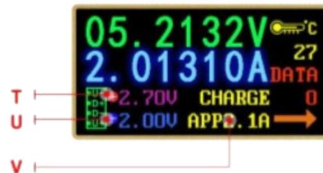
Das Produkt erkennt automatisch ein Gerät mit einem unterstützten Schnelllademodus. Zu diesem Zeitpunkt unterstützt das Gerät QC2.0 (QC3.0) APPLE2.4A / 2.1A / 1A / 0.5A Android DCP (SAMSUNG) Protokoll in der Zukunft)
