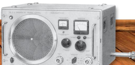
Bild 7: Der Z-g-Diagraf revolutionierte die Netzwerkanalyse.
