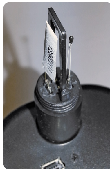
Bild 22: Im Fühlergehäuse des CP11 sind ein kapazitiver Polymer-Feuchtesensor (links) und ein Thermistor (rechts) zur Temperaturmessung untergebracht.
