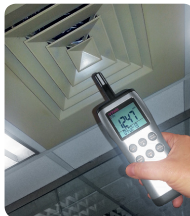
Bild 20: Aus dem Deckenauslass einer Lüftungsanlage sollte eigentlich CO 2 -arme Luft mit etwa 400 ppm kommen ... Mit dem Rotronic Handmessgerät CP11 kann man schnell nachweisen, ob hier alles in Ordnung ist.
