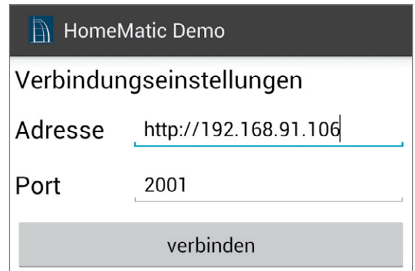
Bild 1: Der Startbildschirm der App: Setzen der Verbindungseinstellungen zum Auslesen der angelernten Aktoren und Sensoren
