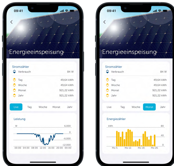
Abbildung 38: Detailseite der Energieeinspeisung
