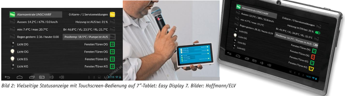
Bild 2: Vielseitige Statusanzeige mit Touchscreen-Bedienung auf 7"-Tablet: Easy Display 7. Bilder: Hoffmann/ELV
