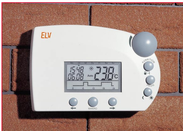
Bild 11: Kann noch mehr, als nur Rollläden steuern – die FHZ 1000 regelt die Heizung, meldet Gefahren und ist in der Lage, bereits komplexe Steuerszenarien über Makros auszuführen.
