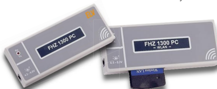
Bild 12: Die PC-gesteuerte Hauszentrale FHZ 1XXX PC ist auch als reichweitenverlängernde WLAN-Version verfügbar und bietet über die passende Steuersoftware ungeheure Steuer- und Überwachungsmöglichkeiten in der Haustechnik.
