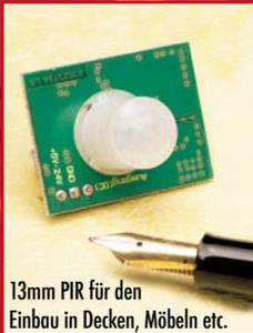
13mm PIR für den Einbau in Decken, Möbeln etc.
