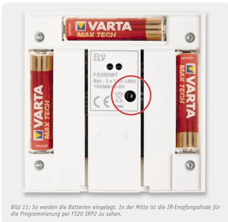
Bild 11: So werden die Batterien eingelegt. In der Mitte ist die IR-Empfangsdiode für die Programmierung per FS20 IRP2 zu sehen.
