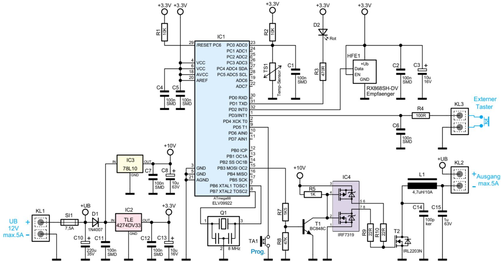
Bild 1: Die Schaltung des LED-Funk-Dimmers
