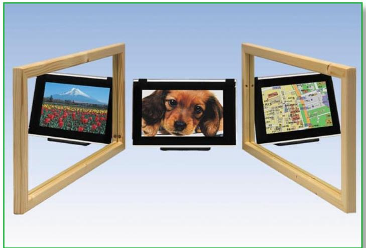
normalen, bildgebenden TFT-LCD liegt. Dabei fungiert diese zweite LC-Schicht als Parallaxenbarriere (Abbildung 15), die das Licht der Hintergrundbeleuchtung nach links und rechts steuert, so dass bei verschiedenen Sichtwinkeln unterschiedliche visuelle Informationen auf demselben Bildschirm angezeigt werden können.
