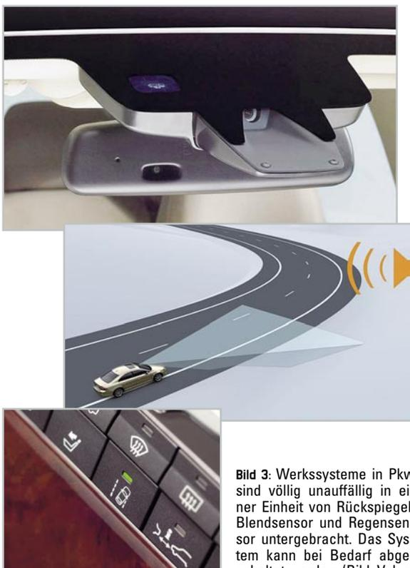
**Bild 3:** Werkssysteme in Pkw sind völlig unauffällig in einer Einheit von Rückspiegel, Blendsensor und Regensensor untergebracht. Das System kann bei Bedarf abgeschaltet werden. (Bild: Volvo)
