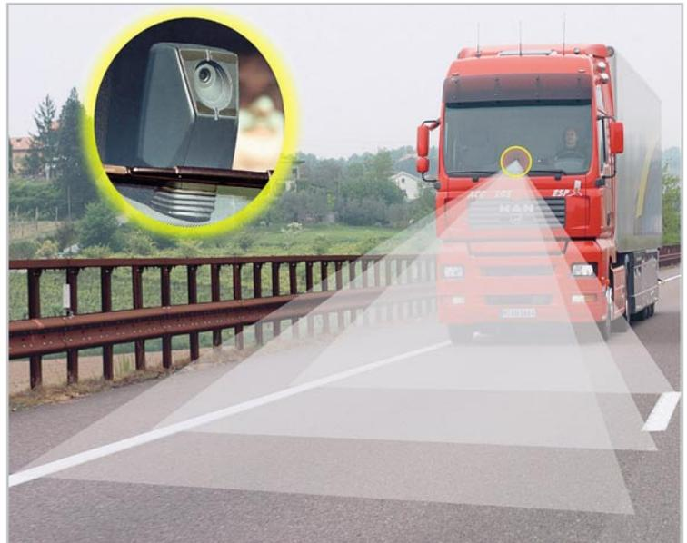
**Bild 2:** Die Kamera hinter der Frontscheibe tastet ständig die Fahrbahnmarkierungen ab. Die Auswertung erfolgt durch intelligente Bilderkennung (Pixelauswertung). (Bild: MAN)
