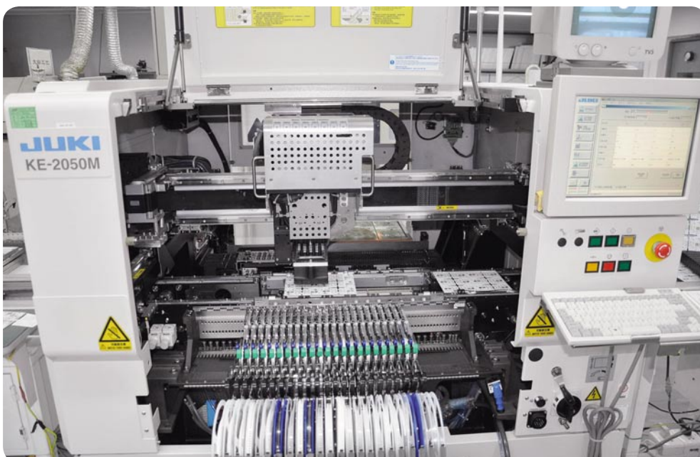
Bild 6: Automatische Leiterplattenbestückung mit Standardbauelementen
