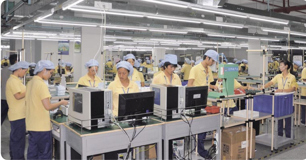
Bild 10: Montagezellen nach dem One-Piece-Flow-Prinzip
