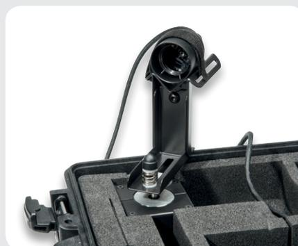
Bild 4: Die automatische Drehvorrichtung zur Aufnahme des Abstrahlwinkels
