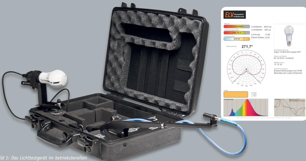
Bild 1: Das Lichttestgerät im betriebsbereiten Zustand mit eingesetztem Prüfling
