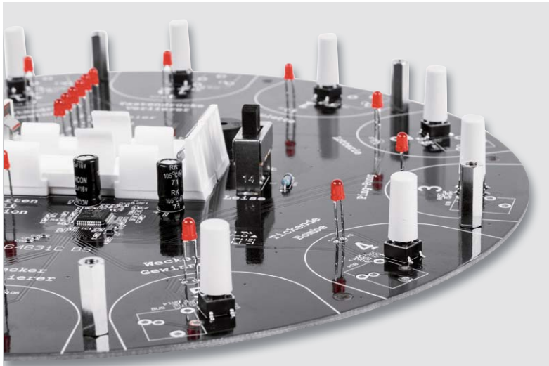
Bild 13: Die Tastkappen sind so weit auf die Taster aufzudrücken, bis lediglich ein Spalt von ca. 1 mm zwischen Kappe und Tasterkörper bleibt.
