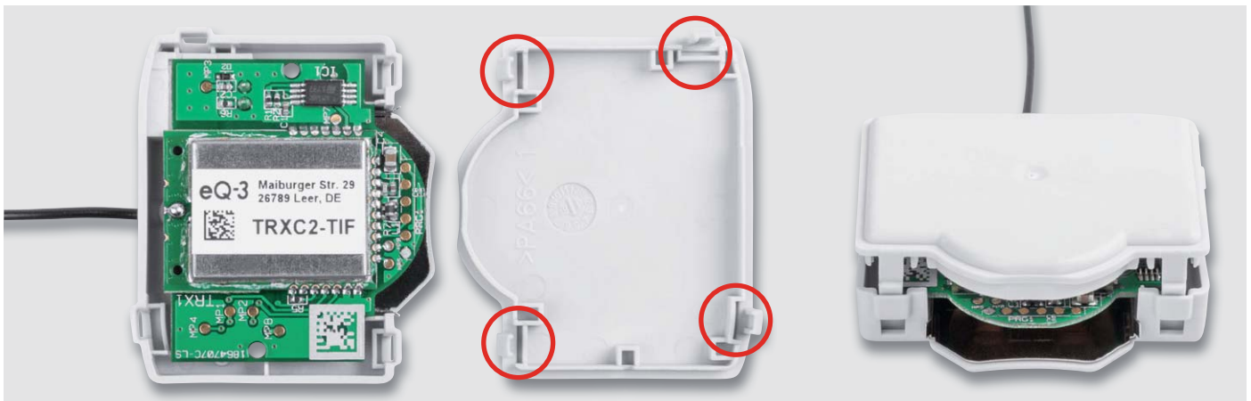
Bild 8: Das Zusammenfügen des Gehäuses erfolgt durch Aufsetzen der Gehäuse- unter- und -ober- schale und Verrasten (rechts) der vier Gehäuse- raste- n.
