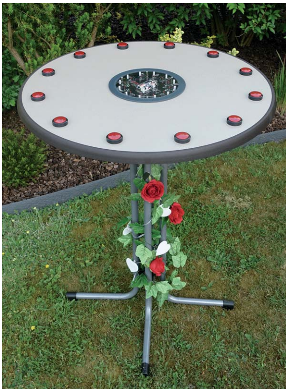
Bild 1: Hier wurde das Spiel in einen Stehtisch eingebaut und für die Bedienung wurden auf der Tischplatte Taster montiert.
