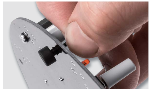
Bild 12: Hier sind die beiden Schiebeschalter zu sehen, die so einzusetzen sind, dass sie genau plan auf der Platine aufliegen.
