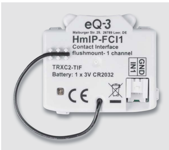
Bild 9: Die Antenne ist wie hier zu sehen im Bogen zu führen und auf dem Gehäuse zu fixieren.
