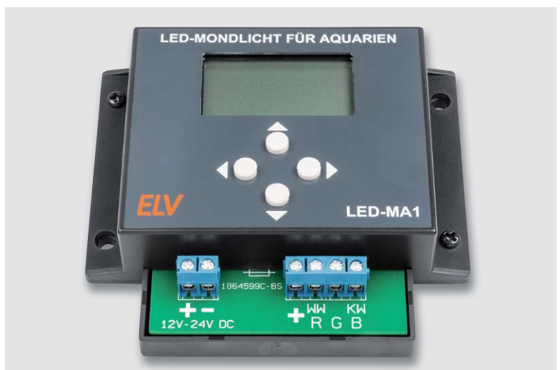
Bild 9: Mit dem Aufsetzen des Gehäuseoberteils und dessen Verschrauben mit den beiden diagonal versetzten Gehäuseschrauben ist die Montage abgeschlossen.
