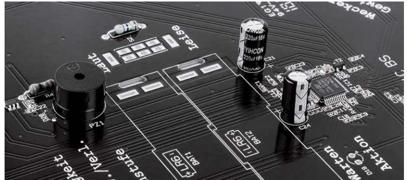
Bild 5: ... gefolgt von den Elkos C21 und C24 sowie dem Buzzer PZ1. Dazu die Hinweise zum polrichtigen Einsetzen beachten!
