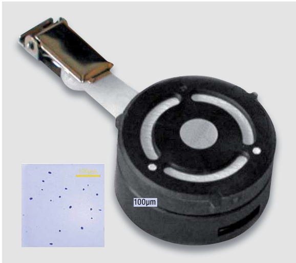
Bild 12: Ein Radondosimeter zeichnet die Spuren der Alphastrahlung auf einem Film auf, der zum Ende der Expositionsdauer von zertifizierten Labors ausgewertet wird.
