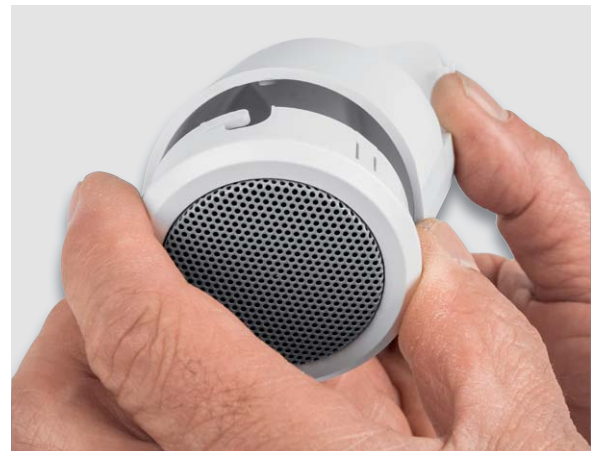
Bild 18: Verrasten des Lautsprechers mit dem Gehäuse
