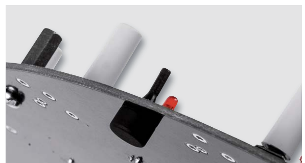
Bild 14: Die GummifüÙe sind, wie hier gezeigt, von unten durch die Platine zu ziehen, bis ihre eingearbeitete Nut in die Platine einrastet.
