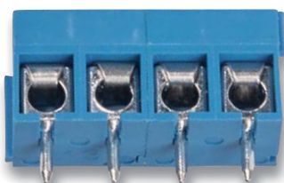
Bild 5: Zwei zweipolige Schraubklemmen sind lückenlos ineinanderzustecken, um eine durchgehende vierpolige Klemme zu erhalten.
