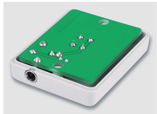
Bild 22: Als Montagehilfe legt man die Platine mit eingesetzter LED kopfüber in die Gehäuseoberschale und lötet die Anschlüsse nun fest.
