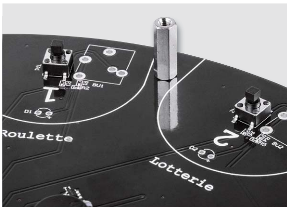
Bild 6: Der erste Bolzen wird, wie hier gezeigt, zwischen Spielfeld 1 und 2 montiert, ...
