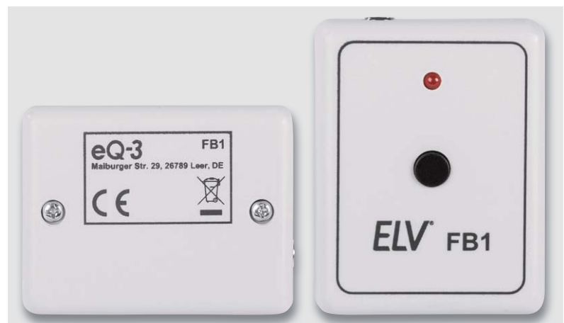
Bild 23: Zum Abschluss werden die beiden Gehäuseschalen miteinander verschraubt. Rechts ist die so fertiggestellte Fernbedienung zu sehen.
