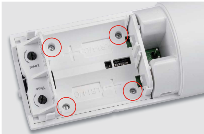
Bild 13: Verschrauben der Leiterplatte mit dem Batteriehalter
