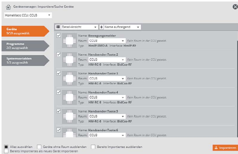
Bild 16: Es werden automatisch alle Geräte bzw. die einzelnen Kanäle der Geräte von der CCU3 abgerufen und aufgelistet. Hier können entweder alle Kanäle oder nur die gewünschten in die Software übernommen werden.
