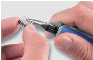
Bild 20: So kann man einzelne Stifte aus einer Stiftleiste herausziehen.
