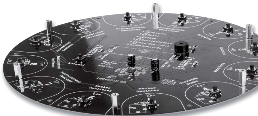
Bild 7: ... der zweite Bolzen zwischen Spielfeld 3 und 4, die weiteren dann entsprechend in jeder zweiten Bohrung.
