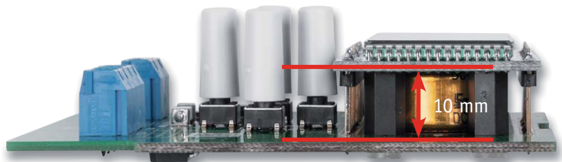
Bild 7: Die Displayplatine ist mithilfe der Abstandhalter so einzulöten, dass sie genau 10 mm Abstand zur Hauptplatine hat. Hier sind auch die aufgesetzten Tasterkappen zu sehen.
