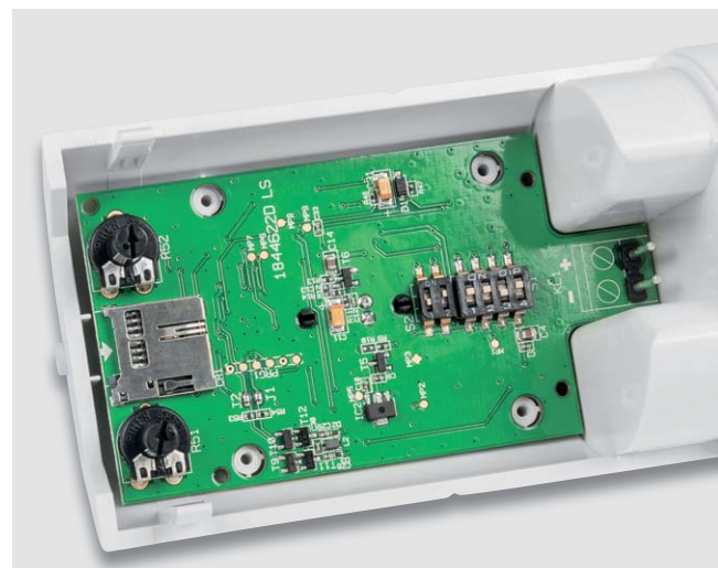
Bild 12: Einsetzen der Leiterplatte ins Gehäuse
