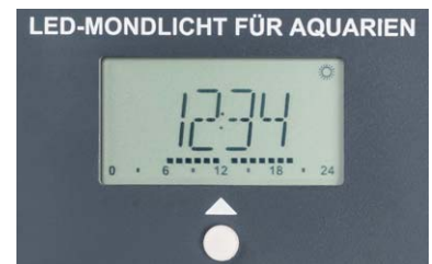
Bild 11: In der Tagdarstellung erscheinen ein Sonnensymbol und in der Balkenleiste die eingestellten Zeitbereiche für den Tagmodus.
