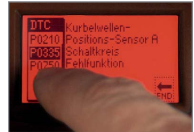
Bild 9: Die meisten Diagnosegeräte geben Fehlermeldungen direkt im Klartext aus, hier links das Duonix PS100, rechts das Diamex CR300.
