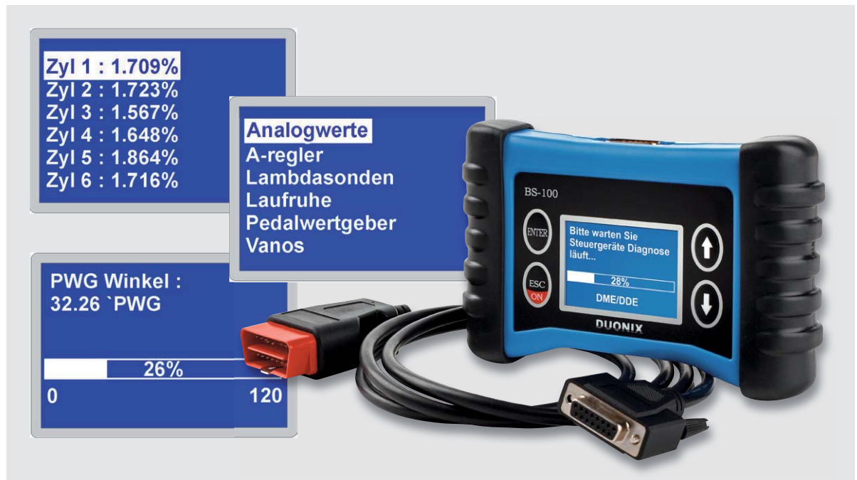
Bild 11: Fahrzeugspezifische Diagnosesysteme wie das BS-100 für BMW ermöglichen eine Tiefendiagnose.
