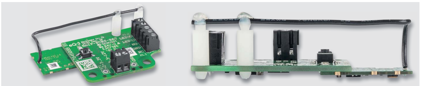
Bild 5: So wird die Sende-/Empfangsantenne verlegt und befestigt
