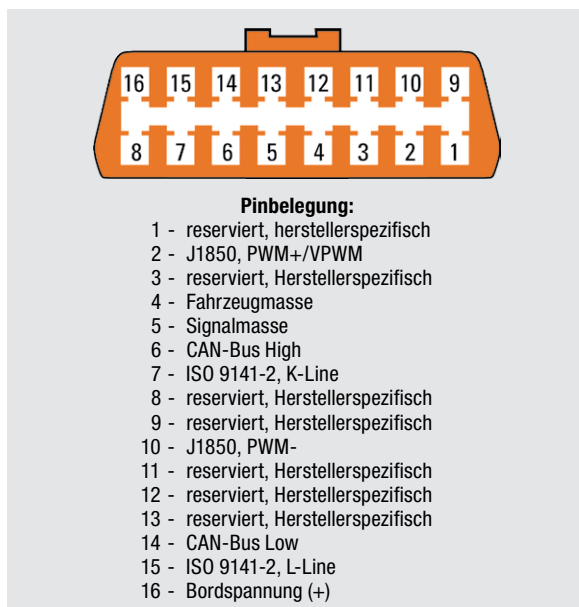
Bild 4: Die Belegung der OBD-2-Buchse im Fahrzeug. Die reservierten Pins können vom jeweiligen Hersteller individuell belegt werden.
