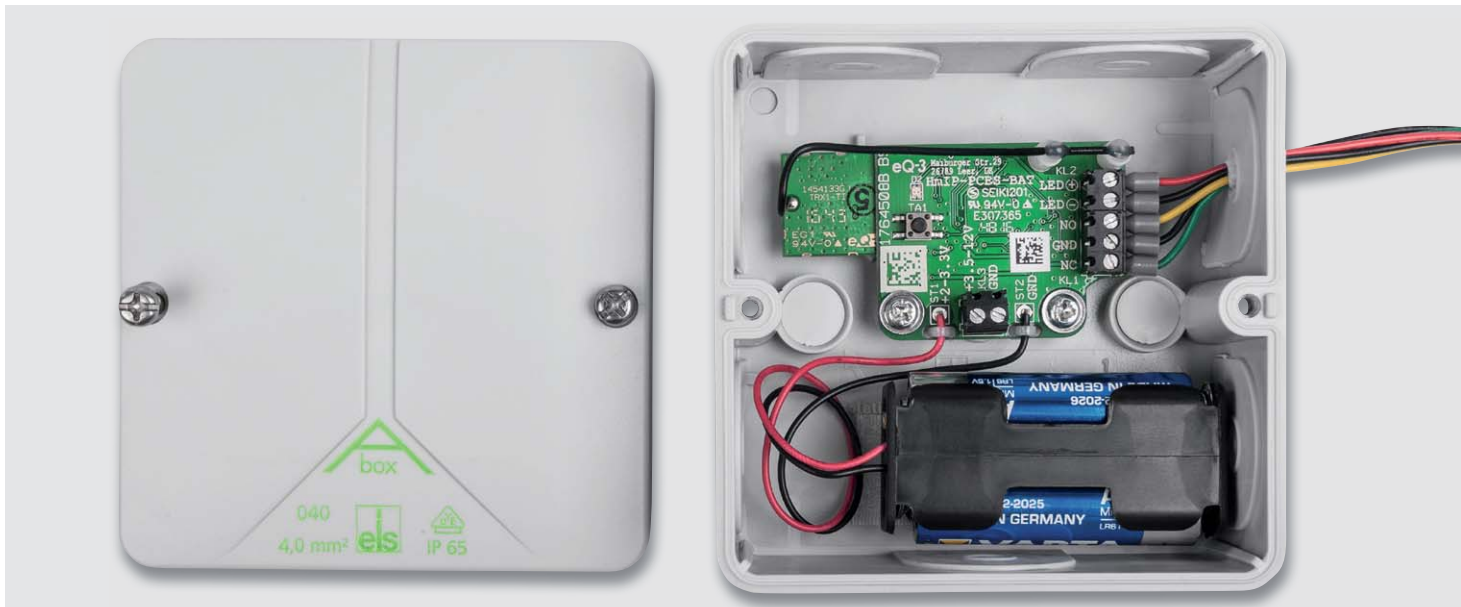
Bild 8: Einbaubeispiel in eine Montagebox Abox 040. Hier sind die Befestigung mit den mitgelieferten Schrauben und die Belegung der Schaltausgänge sowie der LED zu sehen.
