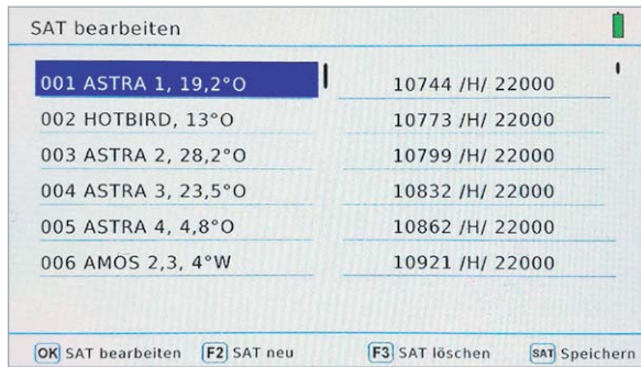
Bild 13: In diesem Menü lassen sich Eintragungen für neue Satelliten anlegen oder bestehende abändern.
