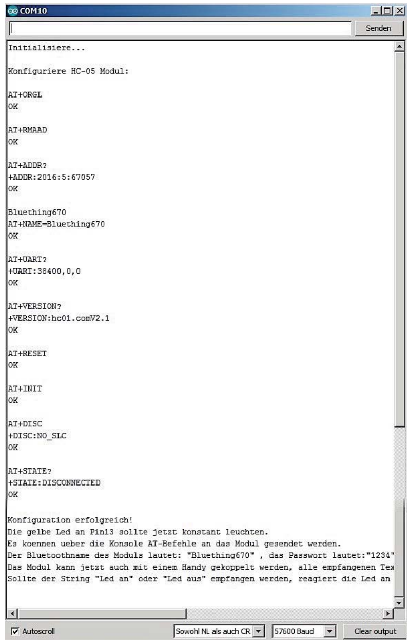
Bild 5: Bluetooth-Modul-Initialisierung im seriellen Monitor
