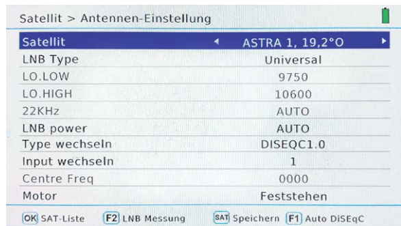
Bild 8: Hier werden elementare Einstellungen in Bezug auf den vorliegenden Antennentyp getroffen, z. B. Typ des LNBS, seine Lokaloszillatorfrequenzen und Betriebsspannungen, DiSEQC-Typ usw.
