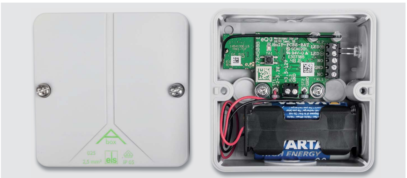
Bild 7: Einbaubeispiel in eine Montagebox Abox 025. Hier sind die Befestigung mit den mitgelieferten Schrauben und die Beschaltung mit der externen Schaltstatus-LED zu sehen.
