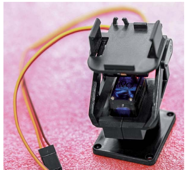
Jeweils ein Tower SG90-Servomotor ist bei dem günstigen „Pan/Tilt Camera Platform Anti-Vibration“-Modul aus Hongkong verbaut. Diese sind hier als Servo0 und Servo1 bezeichnet.
