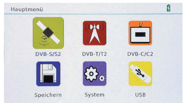
Bild 4: Nach dem Einschalten des Megasat HD 5 Combo erscheint das Hauptmenü auf dem Bildschirm, über dessen Symbole die Grundverzweigung in die weiteren Untermenüs möglich ist.
