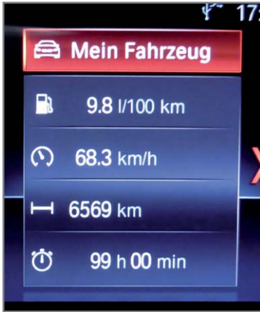
Bild 8: Fahrverlaufsdaten wie diese werden an mehreren Stellen im Fahrzeug gespeichert und können bei Bedarf von dort zu einem Profil zusammengeführt werden.
