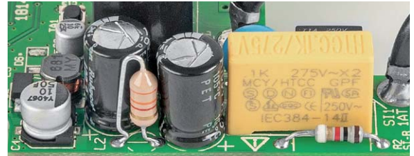
Bild 4: Detailaufnahme der stehenden Bestückung vom L2
