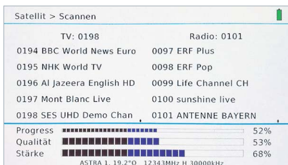
Bild 16: Im unteren Bildschirmbereich werden die Kennwerte des gerade analysierten Transponders ausgegeben.
