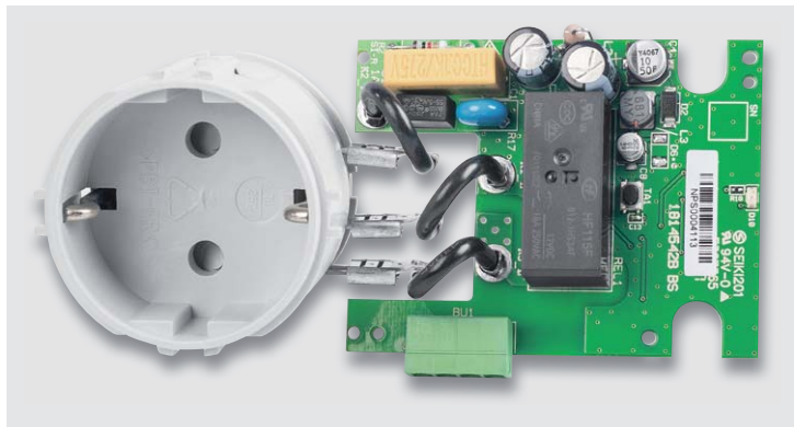
Bild 7: Aufstecken der 6,3-mm-Flachstecker auf den Steckereinsatz
