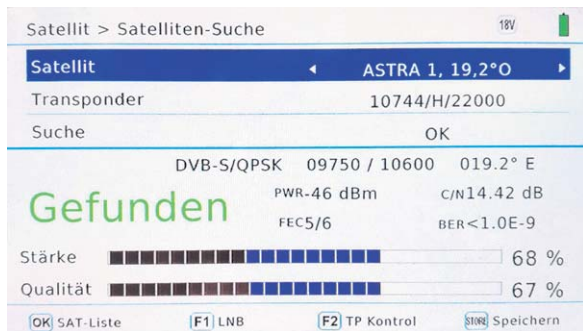
Bild 7: Ist die Antennenschüssel auf den voreingestellten Satelliten ausgerichtet, wird der rote Schriftzug „Suche“ durch den grünen „Gefunden“ ersetzt.
