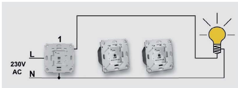
Bild 11: Kreuzschaltung mit Homematic Funk-Schaltaktor für Markenschalter und zwei Homematic Funk-Wandsendern, 2fach, für Markenschalter, Batteriebetrieb
