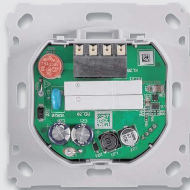
Bild 12: Die Leistungsplatine wird mit der Buchsenleiste in die Stiftleiste der Controllerplatine eingesetzt ...
