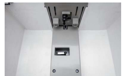
Bild 14: Der Blick in den Aufnahmeaum für den Kondensattank zeigt die beiden Mikrotaster für Voll-Anzeige und Quittierung eines eingesetzten Tanks.
