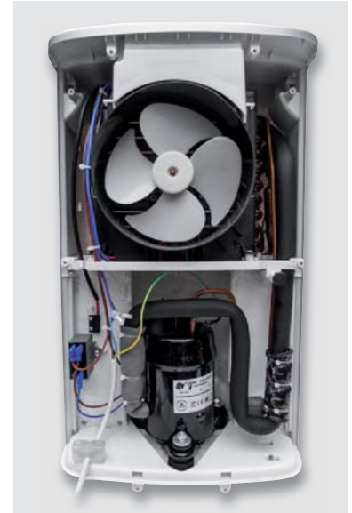
Bild 4: Der Kompressor-Entfeuchter von hinten: unten der Kompressor, darüber der Ventilator
