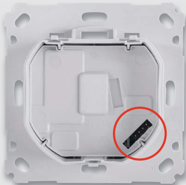
Bild 11: Vor dem Einlegen der Leistungsplatine ist die Isolierplatte einzulegen, und zwar so, dass der Ausschnitt für die Stiftleiste mit dieser korrespondiert.
