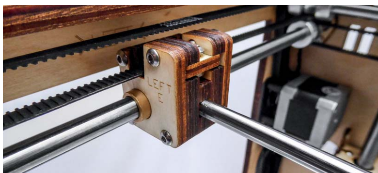
Bild 11: Ausgeklügelte Konstruktionen – die Führungsblöcke für die X-/Y-Achsen
