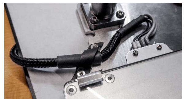
Bild 15: So hält die Zugentlastung das Heizungskabel sicher fest.
