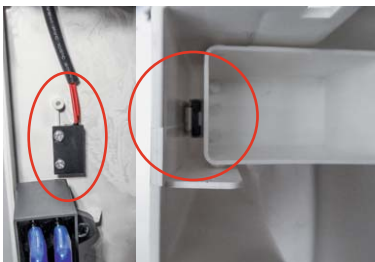
Bild 8: Ein Magnet am Schwimmer (rechts) bedient kontaktlos den Reedkontakt (links).
