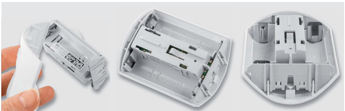
Bild 12: So wird die Gehäusefront aufgesetzt. Das Fixieren im Gehäuse erfolgt ebenfalls durch Verrastungen.
