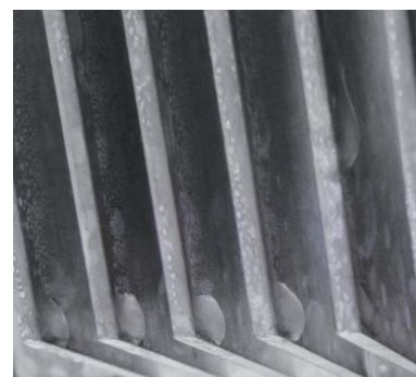
Bild 16: Die kalte Seite des Peltierelements. Hier kondensiert das Wasser, wie man auf dem Detailfoto gut sieht.
