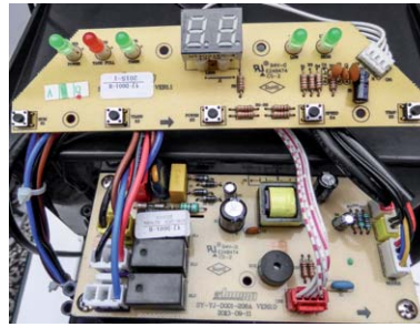
Bild 7: Die Steuerung des Geräts: oben Bedien- und Anzeigefeld mit Mikroprozessor auf der Rückseite, unten Stromversorgung und Leistungsteil
