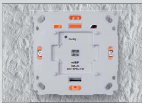
Schritt 4: Schließen Sie den neuen Unterputz-Schaltaktor wie in der Bedienungsanleitung beschrieben an und montieren Sie diesen in der Unterputzdose.
