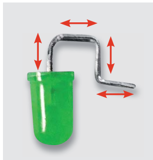
Bild 7: Formt man die LED-Anschlüsse wie hier gezeigt (jeder Pfeil 5 mm) vor, erhält man nach dem Einlöten eine leicht federnde Lage, die die LED sicher positioniert.
