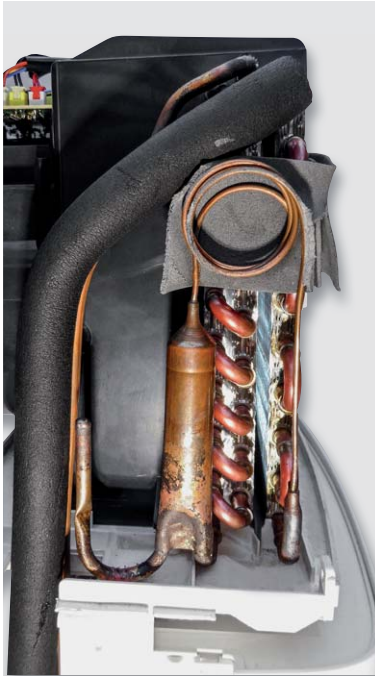
Bild 6: Hier ist das druckmindernde Kapillarrohr zu sehen.
