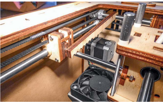
Bild 16: Die Einstellung der X- und Y-Achse erfolgt mit solch einfachen Holzlehren – funktioniert perfekt!
