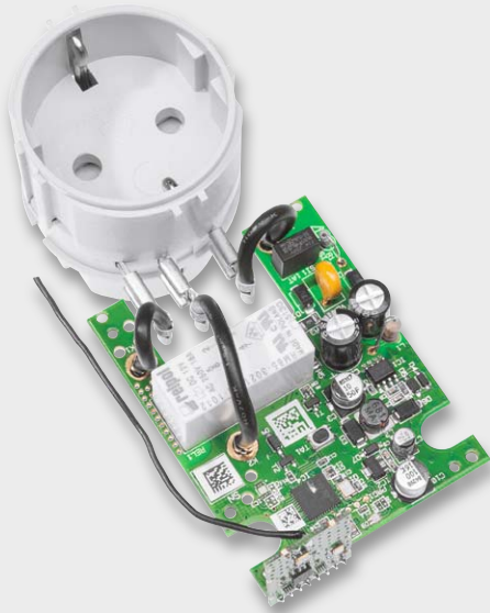
Bild 7: So wird die Steckereinheit angeschlossen.
