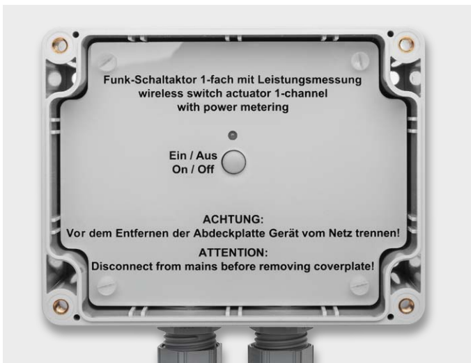
Bild 12: Die Abdeckplatte wird mit vier Kunststoffschrauben fixiert
