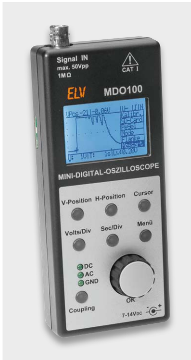
Bild 4: Handheld-DSO als ELV-Bausatz – das MDO100
