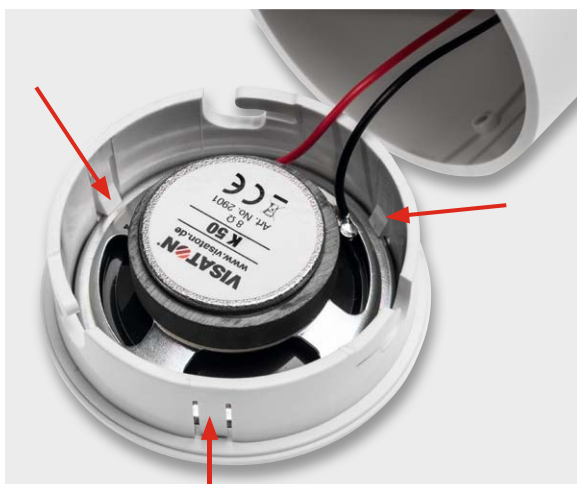
Bild 14: Die Rastnasen des Deckels werden von außen angedrückt.
