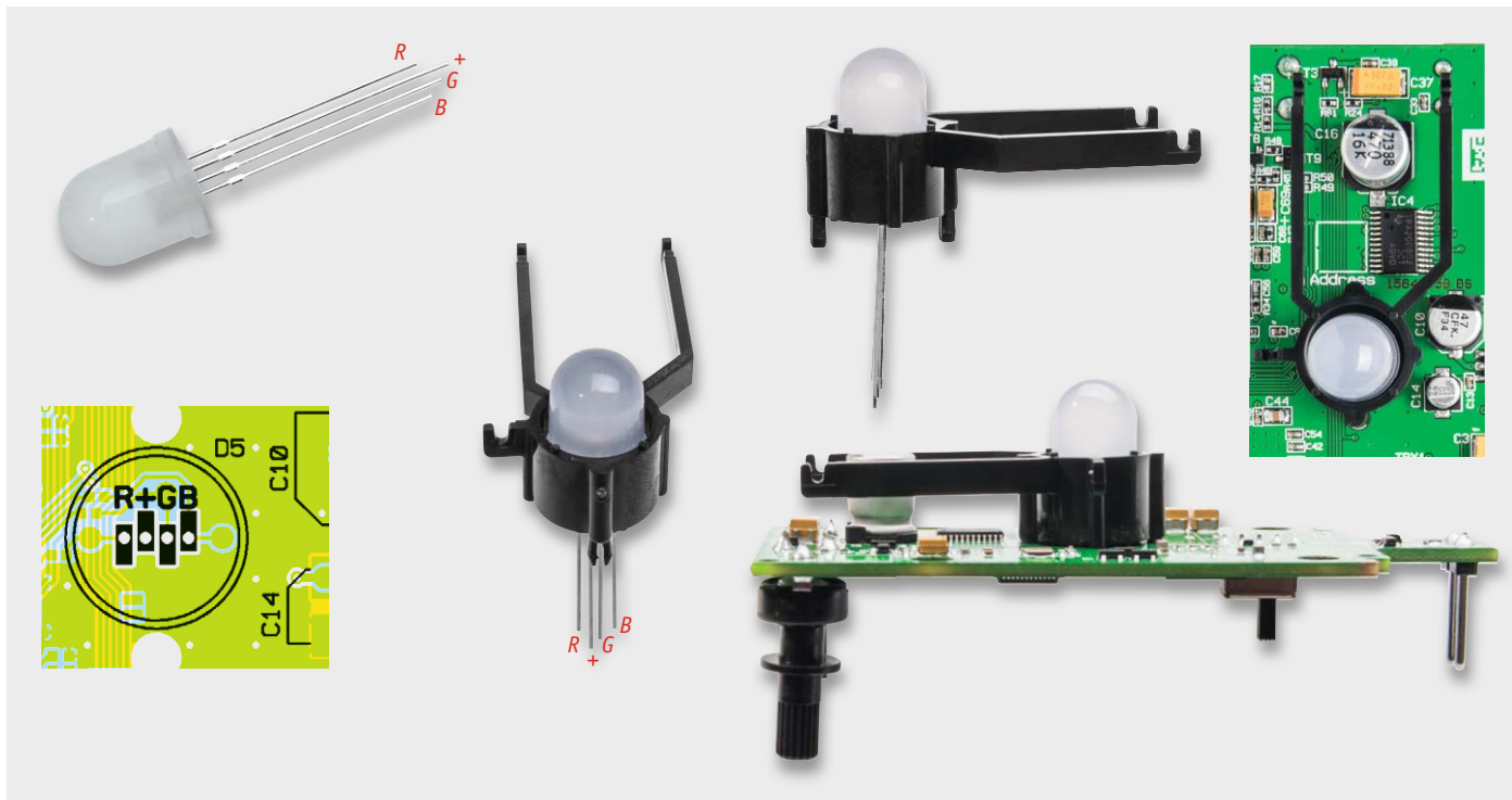
Bild 7: So erfolgen die Bestimmung der Anschlüsse der LED – der längste Anschluss ist die Anode (+) – sowie das Aufsetzen der Halterung auf die LED und das Einsetzen in die Platine (in die Haltelöcher einsetzen).
