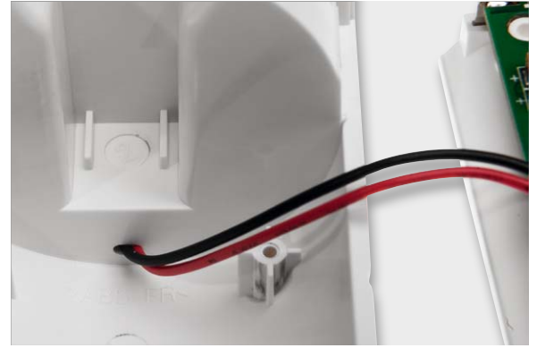
Bild 11: ... danach führt man das andere Kabelende durch das Gehäuseloch des Gerätegehäuses.
