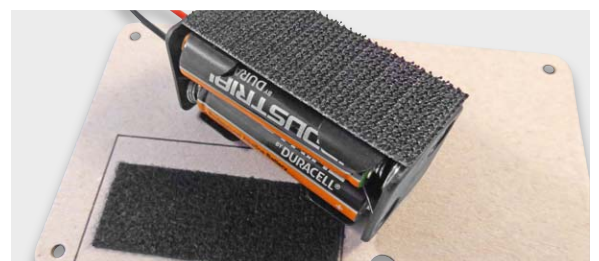
Bild 17: So werden die mitgelieferten Klett-Klebebandstücke auf die Rückwand und den Batteriehalter aufgebracht.
