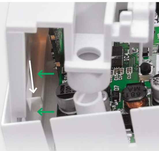
Bild 9: Das Einsetzen der Kunststoffeinheit mit dem Tasterstößel muss genau entsprechend den Hinweisen in der Aufbaubeschreibung erfolgen.
