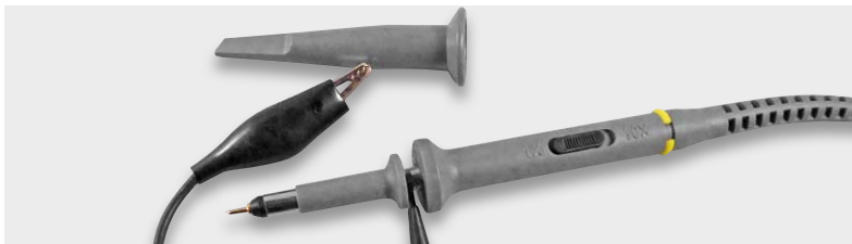
Bild 11: Als Alternative zu den mitgelieferten Messleitungen ist auch ein normaler Oszilloskop-Tastkopf einsetzbar.
