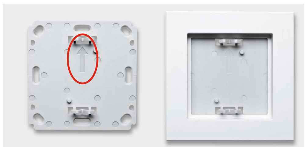
Bild 19: Links die Montageplatte, rechts ist der auf diese aufgesetzte Rahmen zu sehen. Der Pfeil auf der Montageplatte (siehe Markierung) muss nach oben zeigen.
