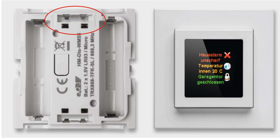
Bild 20: Beim Aufsetzen des Anzeigerahmens ist ebenfalls darauf zu achten, dass die eingepprägten Pfeile nach oben weisen. Rechts das fertig montierte Gerät.
