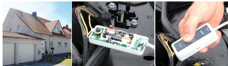
Bild 1: Mit einer anlernbaren Blinkfolge der Lichthupe lässt sich der HomeMatic-Funksensor für elektrische Impulse „HM-Sen-EP“ für das Öffnen von Garagentoren einsetzen.
