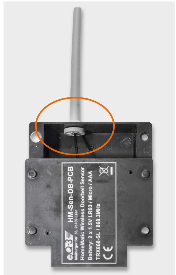
Bild 6: Der Antennendraht wird in die Antennenhülle eingeführt und gleichzeitig das Gehäuseunterteil mit der Platine nachgeführt.
