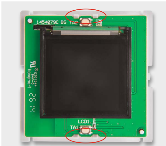
Bild 16: So erfolgt das Aufsetzen der Controllerplatine auf die Funkplatine. Dabei ist sorgfältig auf das Einführen der Steckkontakte des 12-poligen Steckverbinders sowie auf das saubere Einrasten der Platinenhalter zu achten.
