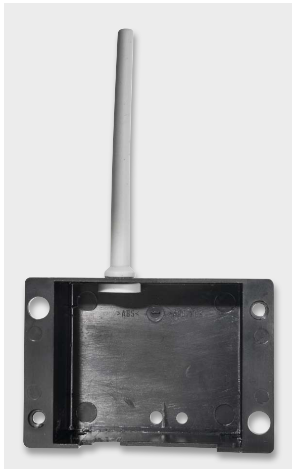
Bild 4: So wird das Gehäuseoberteil mit der Antennenhülle versehen.
