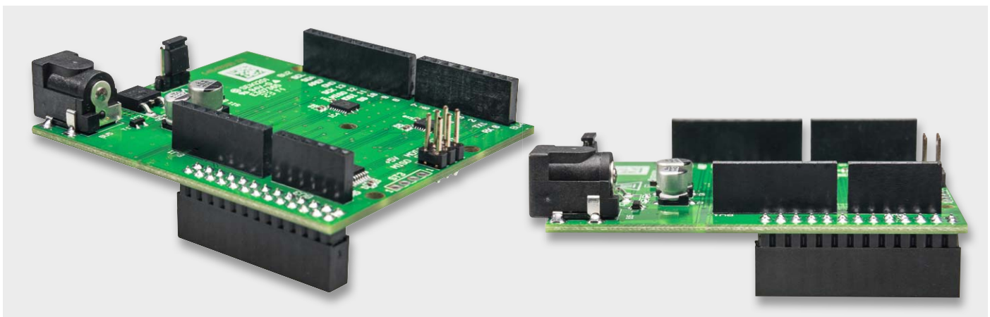
Bild 3: Die bestückte Platine, rechts ist die plane Lage der Buchsen auf der Platine gut zu sehen
