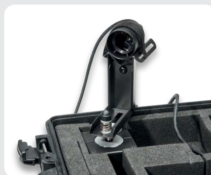
Bild 4: Die automatische Drehvorrichtung zur Aufnahme des Abstrahlwinkels
