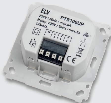
Bild 14: Letzter Schritt der UP-Gerätemontage ist das Aufsetzen und Verrasten des Gehäuseunterteils.
