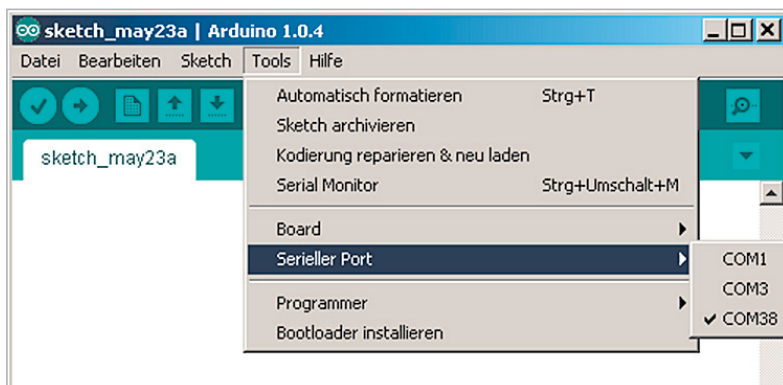
Bild 10: Auswahl des COM-Ports
