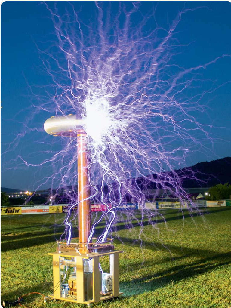
Bild 6: Krönung des Selbstbaus von Tesla-Spulen – mehr als 2 m hoch, meterlange Entladungen, Spannungen im Megavoltbereich. Quelle: Matthias Böck
