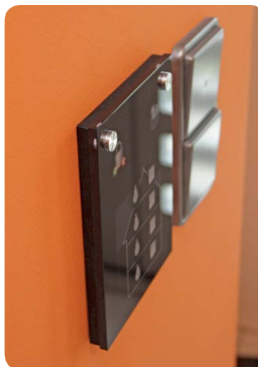
Bild 15: Hier ist die an den Rändern ebenfalls schwarz lackierte Holzplatte zu sehen.
