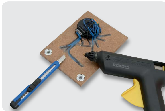
Bild 8: Für eine stabile Lage der LED-Verkabelung werden die zuvor eingebrachten Kanäle flächenbündig mit Heißkleber gefüllt.
