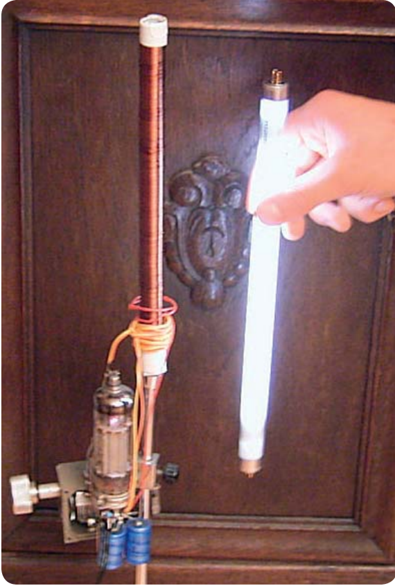
Bild 5: Der kleine Generator erzeugt genug Energie, um eine Leuchtstofflampe daneben aufleuchten zu lassen. Quelle: B. Kainka
