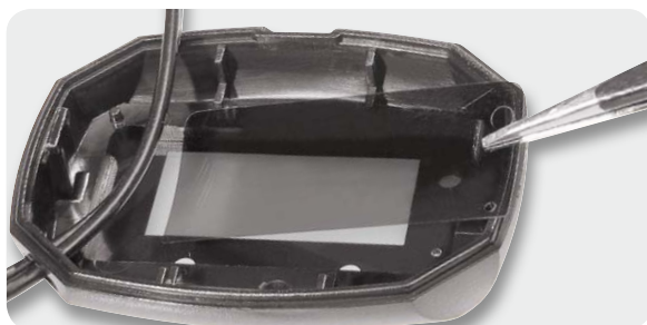
Bild 8: Das Einsetzen der Tönungsfolie für die Anzeige
