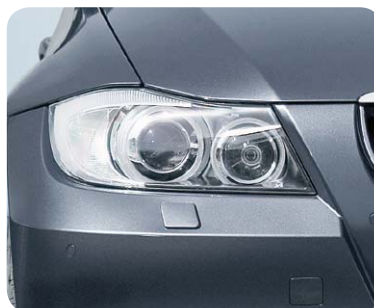
Bild 6: Der typische Linsenscheinwerfer bei BMW – eine Kombination aus fester Linse und Reflektor
