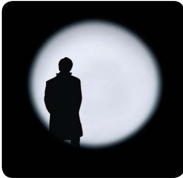
Bild 10: Kreisrundes, homogenes Linsenlicht bei defokussierter Lampe
