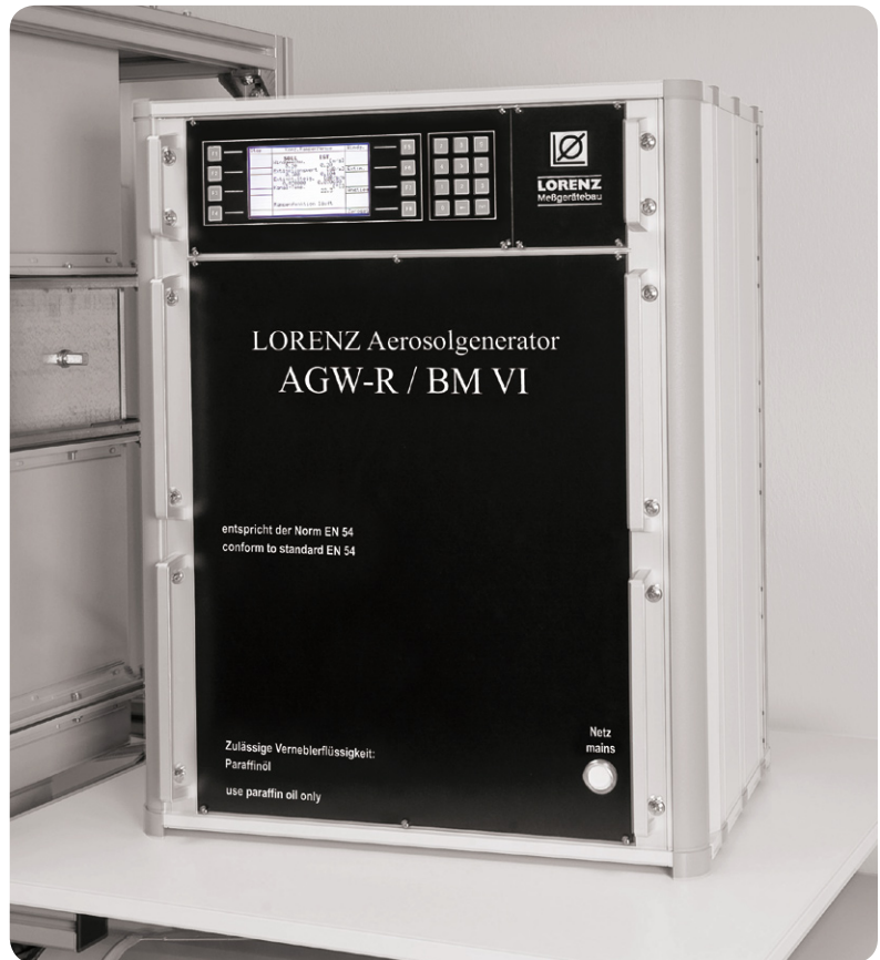
Bild 2: Aerosolgenerator mit Prozessrechner
