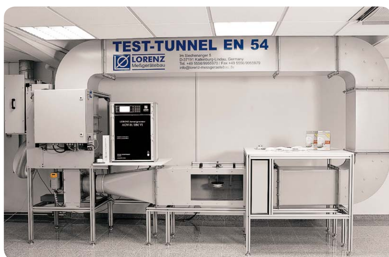
Bild 1: Rauchmelder-Prüfkanal nach EN 54
